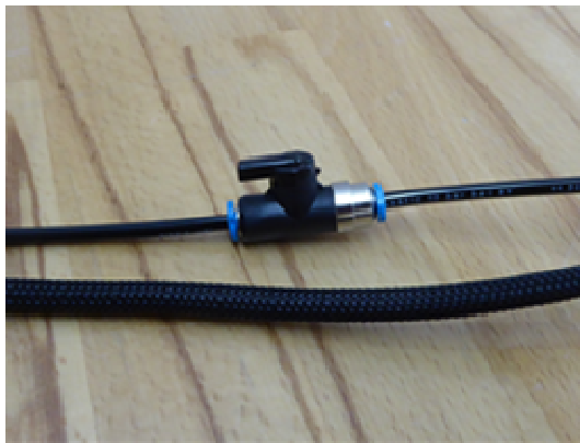
Fig. 17. Air flow- open
