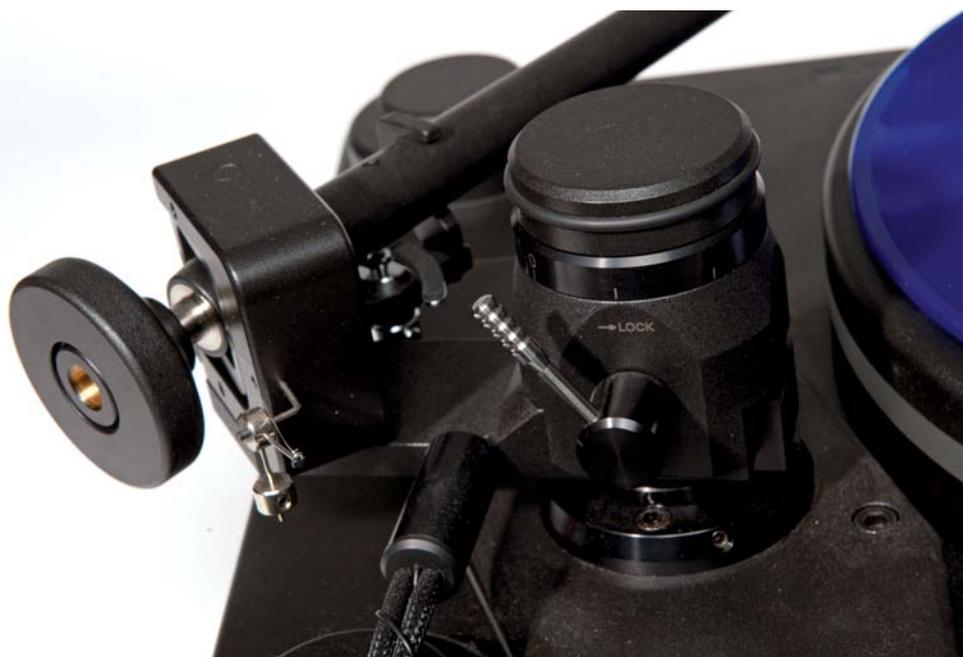
gnée avec un angle vertical d'attaque moyen recommandé d'une vingtaine de degrés, on pourra ouvrir ou fermer cet angle de quelques degrés en tournant la molette. Cette manipulation qui ajustera la position de la pointe dans le microsillon aura bien entendu une répercussion sur l'équilibre spectral en fonction de chaque cellule utilisée. Cette opération possible pendant la lecture d'un disque facilitera les comparaisons à la volée.
