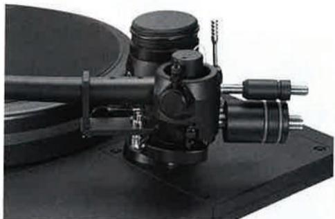
4ポイント・トーンアームは、アルミのソリッド材から削り出し加工されたアームチューブを持つ。軸受けは水平回転、垂直動作双方をオイルダンプでき、写真に見えるふたつのネジと、それぞれの下部にあるオイル槽がそのダンパー機構。ネジを外したりオイルを空にすることでもオイルダンプを使わない選択肢もある。針圧と高さをひじょうに細かく精密に調節できるのも特徴である。
