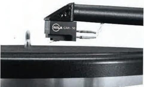
サファイアカンチレバーと4N銀コイル線を特徴とするCAR50は同社のセカンドトップとなるカートリッジで、本国では全6モデルをラインナップしている。なお、4ポイント・トーンアームのヘッドシェル部分は着脱可能。
